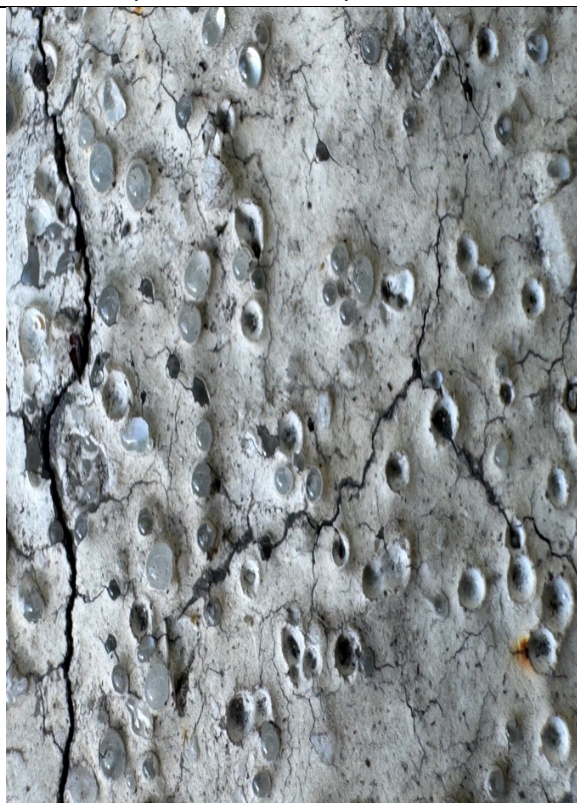
Състояние на пътната маркировка М1 (средна разделителна), погледнато с увеличителен уред, от който е видна драстичната загуба на светлоотразителни перли (посока на движение от гр. Монтана към гр. Видин)
