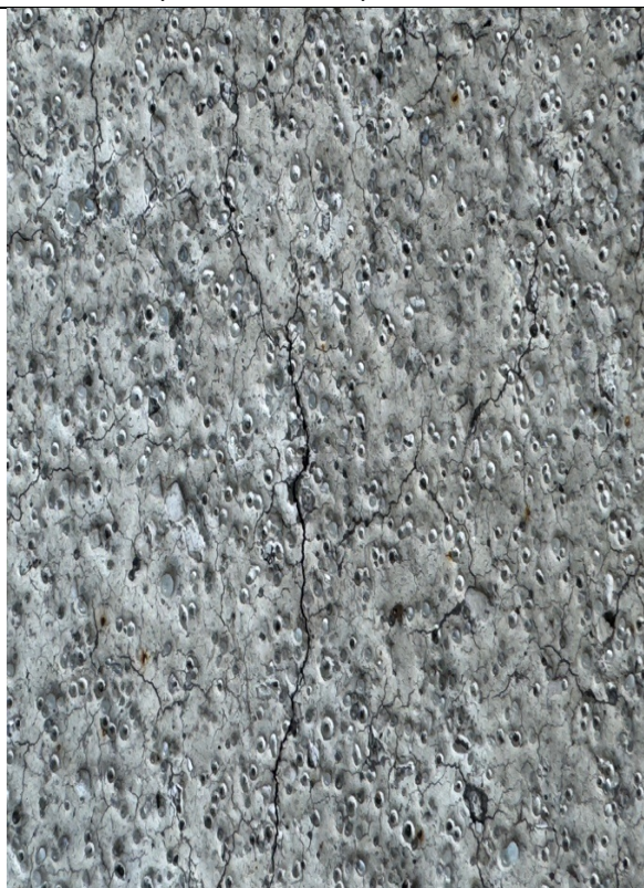
Състояние на пътната маркировка М1 (средна разделителна), погледнато с увеличителен уред, от който е видна драстичната загуба на светлоотразителни перли (посока на движение от гр. Видин към гр. Монтана)
