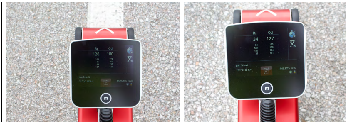
Измерване на състоянието на пътната маркировка с ретрорефлектометър в платното за движение от гр. Димитровград → към гр. Хасково
