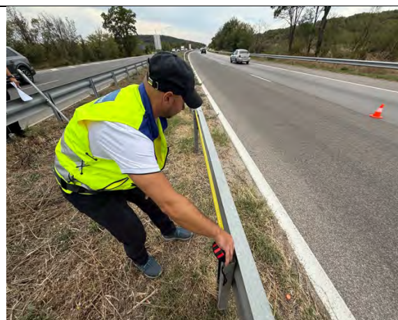
Разстояние между стълбчетата 2,00 m
