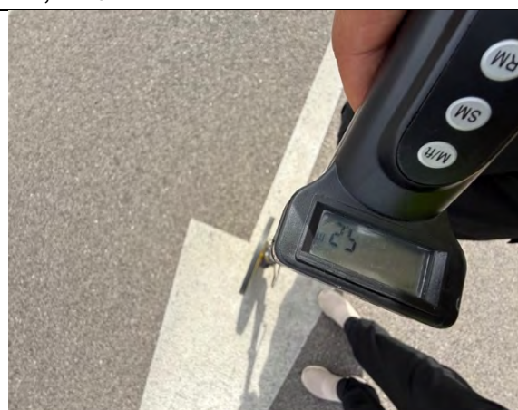
Измерване на стрелки М10 с цел установяване на съответствие с Приложение 11 чл.27, т. 1 от Н2
